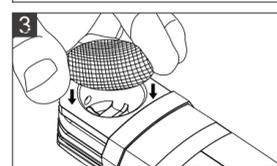
Coloque el filtro de la malla en la parte superior de la cámara de combustión y presione hacia abajo con un dedo para asentarlo en el fondo de la misma cámara. Coloque una pequeña cantidad de astillas de madera (o materiales deseados para ahumar) en la cámara de combustión.
