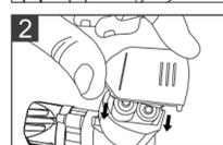
Inserte las 4 pilas AA asegurándose que queden orientadas en la posición que se indica en el interior del compartimento de pilas.
